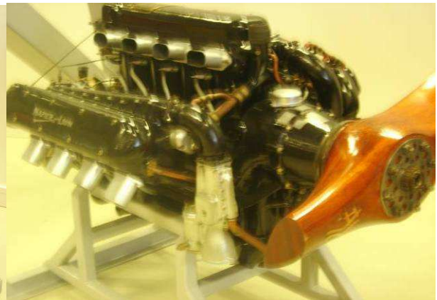
Moteur à trois rangées de cylindres.
