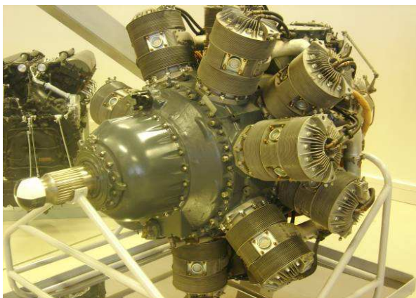
Double étoile 14 cylindres, Hercules.
