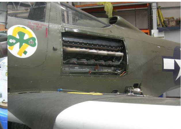
Moteur central, bon pour le centrage, mais rare P 39 Airacobra.
