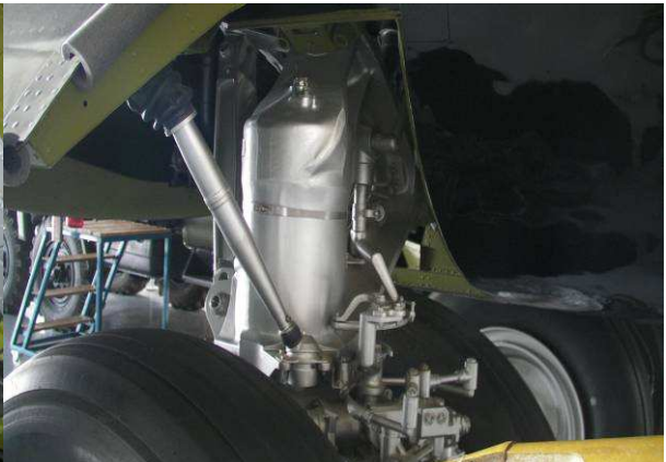
Vérification d'un œil expert (logement train B52). Une des Jambes de train, masse maxi 221 400kg.
